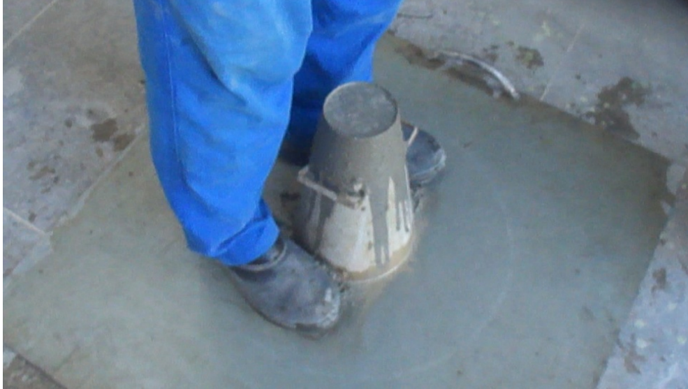
Figura 1 - Execução do ensaio de espalhamento
