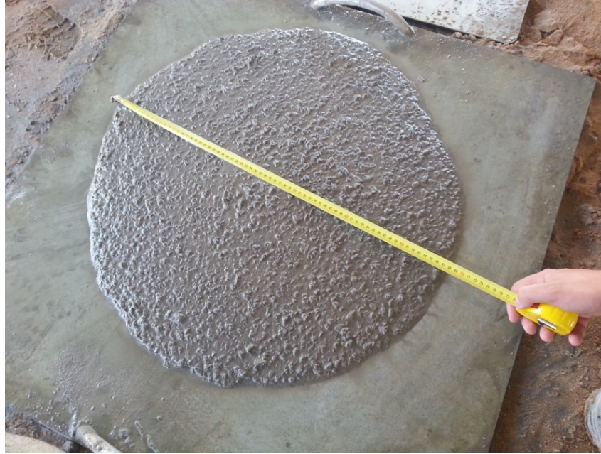
Figura 18 - Ensaio slump flow na obra
