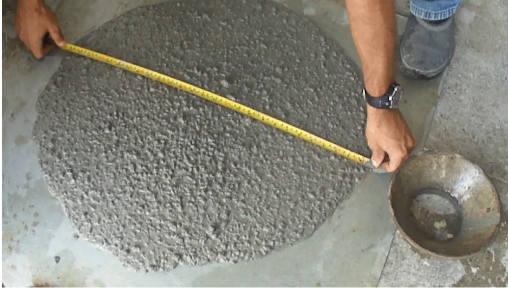
Figura 13 - Ensaio slump flow no laboratório
