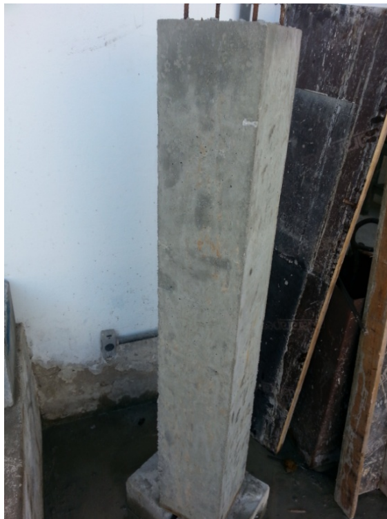
Figura 17 - Aspecto do pilar confeccionado em laboratório
