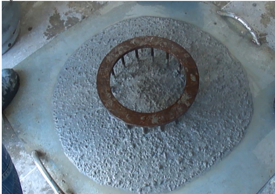
Figura 14 - Ensaio Anel J no laboratório
