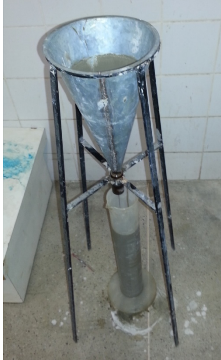
Figura 11 - Ensaio Cone de Marsh em laboratório
