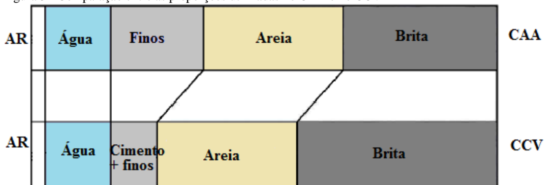
Figura 3 - Comparação entre as proporções utilizadas no CAA e no CCV
