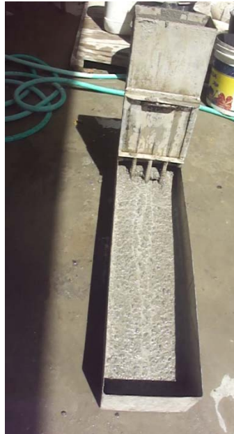
Figura 15 - Ensaio Caixa em L em laboratório
