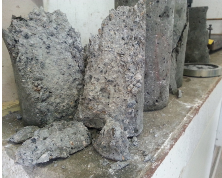
Figura 16 - Aspecto do corpo de prova de CAA
