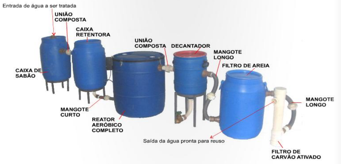
Figura 71 - Esquemática do equipamento para tratamento das águas cinzas. Fonte: (Manual TAC, 2010)
