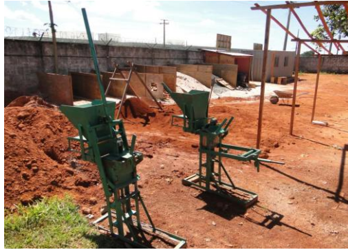
Figura 32 – Fabricação local dos tijolos. (Fonte: acervo fotográfico do I Congresso Internacional de Obras Públicas Sustentáveis, 2010)
