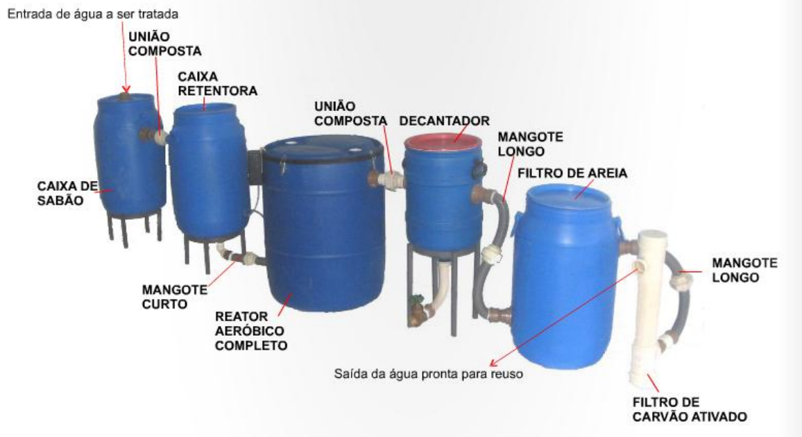
Figura 15 - Esquemática do equipamento para tratamento das águas cinzas. (Fonte: Manual TAC, 2010)
