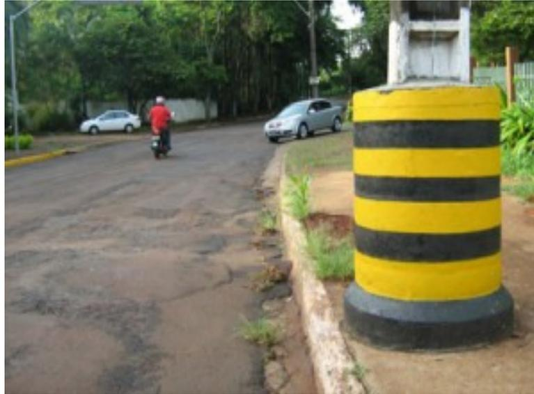
Figura 1.4 - Proteção de poste na cidade de Londrina-Para (fonte: <http://www.apauta.com.br/copel-testa-dispositivo-para-protoger-postes-contr-colisoes-205.html>)
