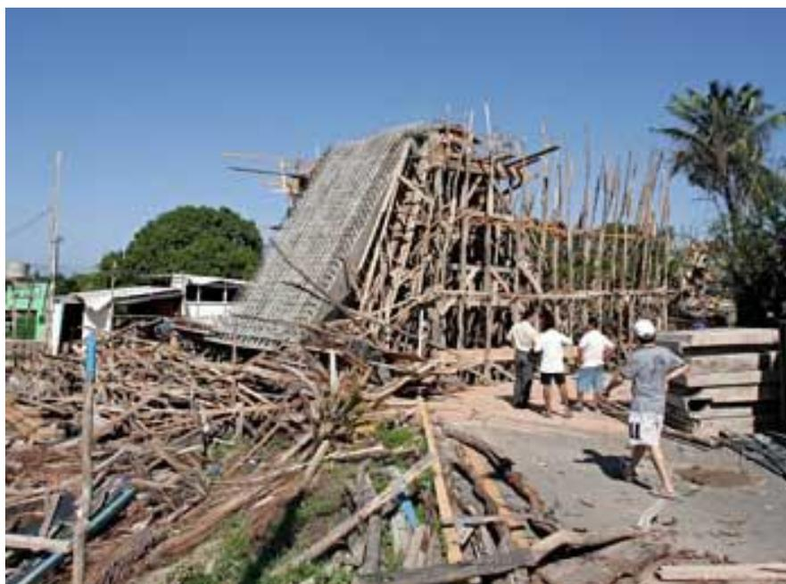
Figura 8 - Colapso de torre de escoramento de madeira utilizada na construção do viaduto na rodovia CE-040 (Diário do Nordeste, 2008).
