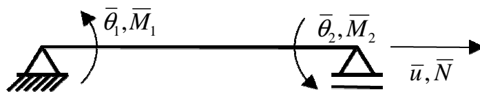
Figura 32 – Graus de liberdade e esforços respectivos do elemento.
