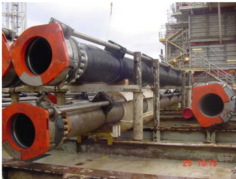
Figura 4.5: Junta de riser de material compósito para perfuração.
