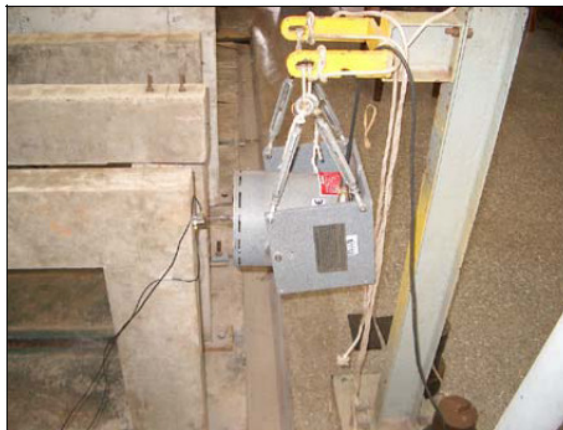
Figura 9 - Ensaio dinâmico com excitador.
