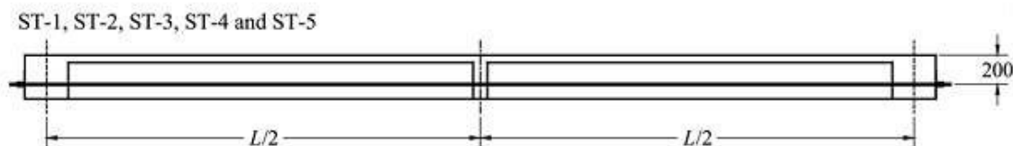
Figura 59 - Detalhe das vigas ST ensaiadas por Tan e Ng (2006) (unidade em mm)
