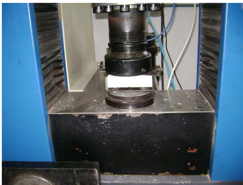
Figura 12 – Ensaio de resistência à tração na flexão.
