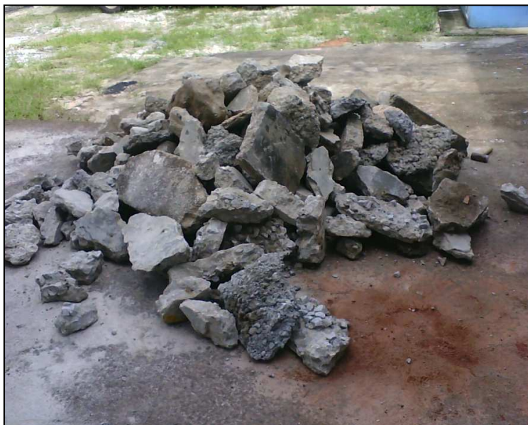
Figura 3 – Resíduos de concreto a serem britados.
