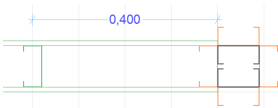
Figura 60 – Sobreposição entre a configuração dos perfis de vão e a configuração do encontro em X.
