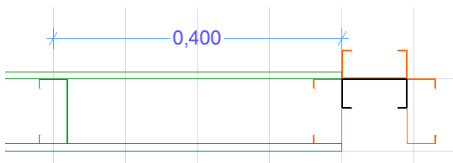
Figura 59 – Sobreposição entre a configuração dos perfis de vão e a configuração do encontro em T.
