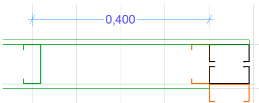
Figura 58 – Sobreposição entre a configuração dos perfis de vão e a configuração do encontro em L.
