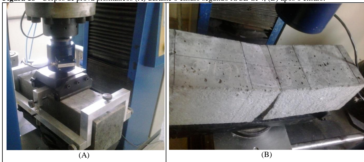
Figura 18 - Corpos de prova prismáticos (A) durante o ensaio segundo JSCE-SF4, (B) após o ensaio.
