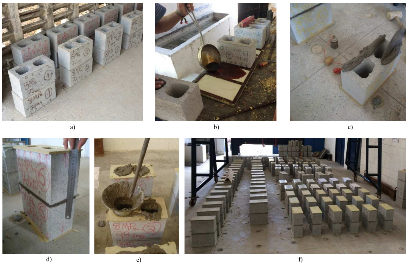
Figura 11 – Etapas de produção dos prismas: a) identificação dos blocos; b) capeamento dos blocos com enxofre; c) assentamento dos blocos; d) verificação da espessura da junta; e) grauteamento dos furos; f) lote de prismas portos para serem ensaiados.
