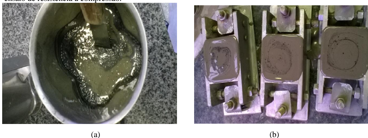
Figura 4.25 – Pastas misturadas: (a) pasta recém-misturada. (b) pastas no molde dos corpos de prova para ensaio de resistência à compressão.
