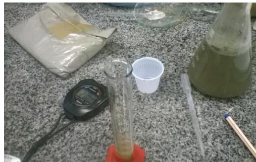
Figura 3.4 – Materiais utilizados para se determinar o teor de água livre.
