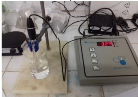
Figura 30 - Leitura do potencial desenvolvido
