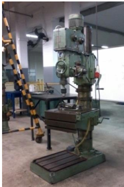
Figura 27 - Furadeira de Coluna - IFCE
