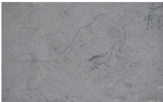
Figura 37 – Painel e medição das fissuras da argamassa TD 100%
