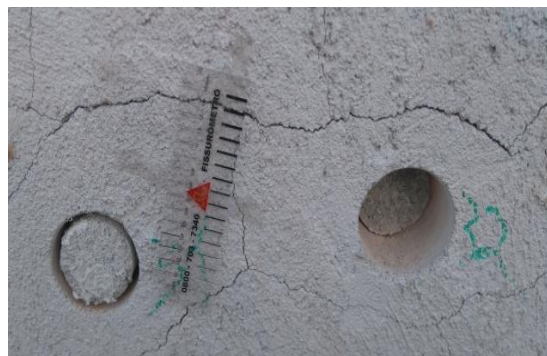
Figura 37 – Painel e medição das fissuras da argamassa TD 100%
