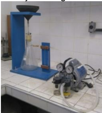
Figura 12 – Equipamento de retenção de água
