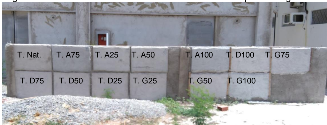
Figura 20 – Parede construída ao lado LMCC com os 13 painéis argamassados
