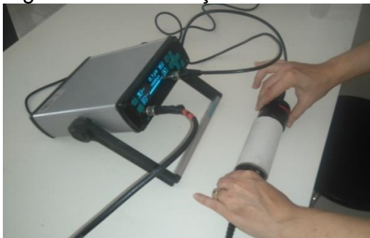
Figura 14 – Realização do ensaio de ultrassom
