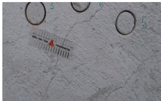
Figura 37 – Painel e medição das fissuras da argamassa TD 100%
