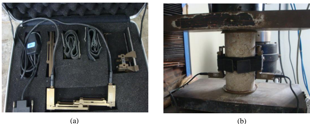
Figura 30 – (a) Equipamento e (b) execução do ensaio de módulo de elasticidade.
