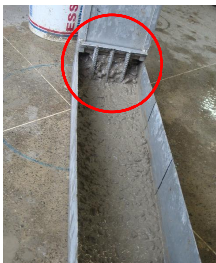
a) CAA com bloqueio dos agregados.
