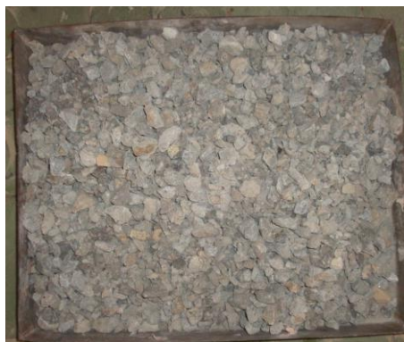
Figura 19 - Agregado graúdo reciclado de concreto obtido entre as peneiras # 25 mm e # 4,75 mm.
